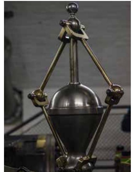
Osa höyrykoneen nopeudensäätimen mekanismista.
