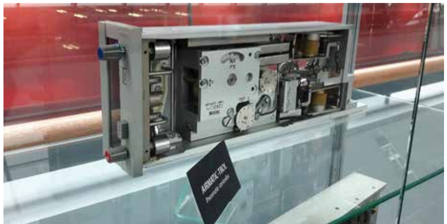
Honeywellin valmistama, kentälle asennettava pneumaattinen PID-säätäjä.
