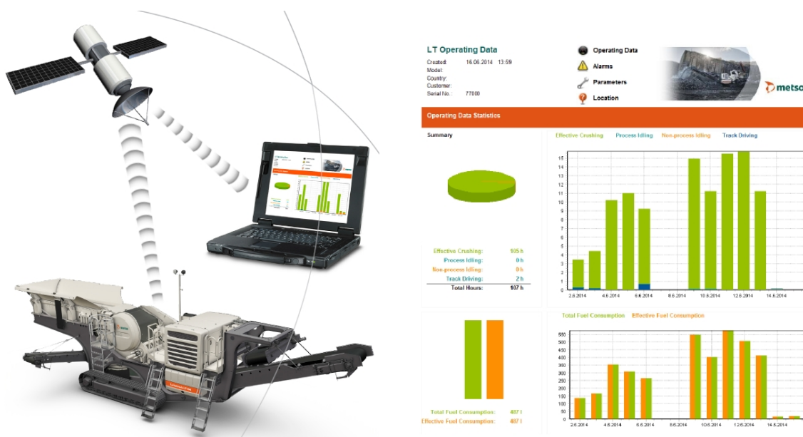
Kuva 1. Satelliittipohjainen raportointi- ja kunnossapitoympäristö tuottaa satelliittiyhteyden kautta murskauslaitteilta saaduista konetiedoista raportteja etäseuranta varten ja työllistä ennakoivan kunnossapidon tarkastus- ja huoltotoimenpiteitä varten.
