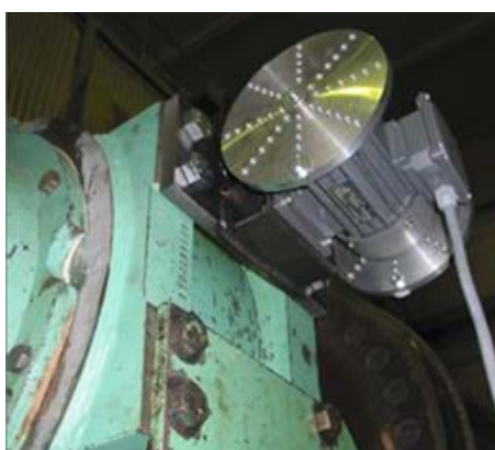
Kuva 4. Sähkömoottoritäryllä varustettu paperikoneen telan laakeripesä käyttötilanteessa (vasen) /5/ ja tasapainotilan määrittämiseksi varten voimaimpulsilla herätettävä joustava tela (oikea) /6/.
