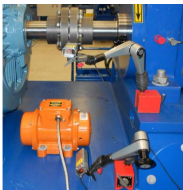
Kuva 3. Siniherätelaite ja mittaukseen liittyvää anturointia vasemmalla (2 triggeriä ja kiihtyvyyssantureita), oikealla herätelaitteen aiheuttama kiihtyvyyssvaste taajuusalueella 15—55 Hz laitteen kolmella ajonopeudella (100, 1750 3500 r/min).
