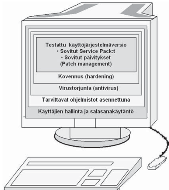
Kuva 27. Työaseman suojaaminen automaatioympäristössä.
