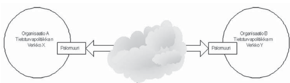
Kuva 14. Suojattujen verkkojen yhteen liittäminen ja tietoturvamonitorointi.
