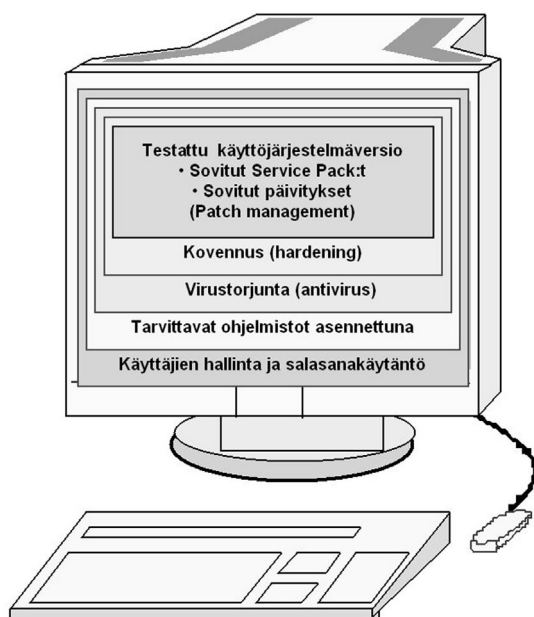
Kuva 27. Työaseman suojaaminen automaatioympäristössä.
