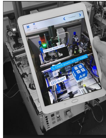
Kuva 9. Festo MPS laitteiston AR –sovellus.
