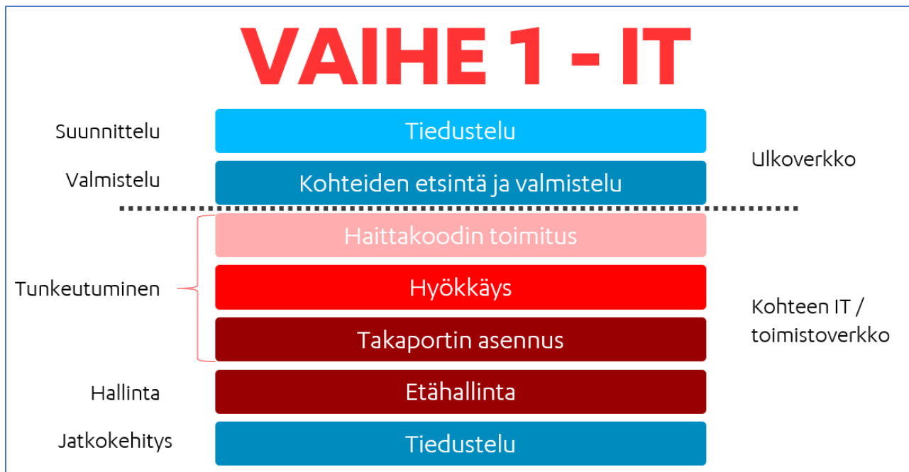
Kuva 1 Automaatiojärjestelmiä vastaan tehtävät hyökkäykset lähtevät usein liikkeelle IT- ja toimistoverkon järjestelmistä, joihin hyökkääjä hankkii ensin pääsyn.
