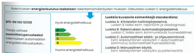
Kuva 3. Standardin ISO 52120 luokat rakennusautomaatiolle [2]
