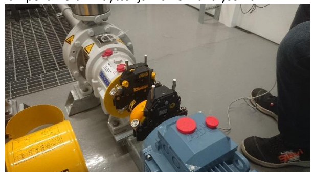
Kuva 9. Linjaus prosessiautomaation laboratoriossa. (Promaint 2023)
